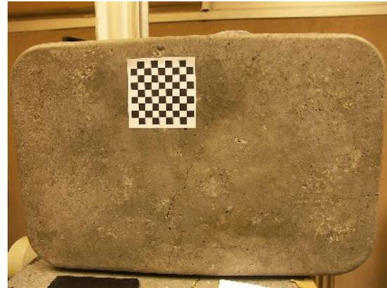
Fig. 35 : Mire pour la détermination de paramètres extrinsèques
