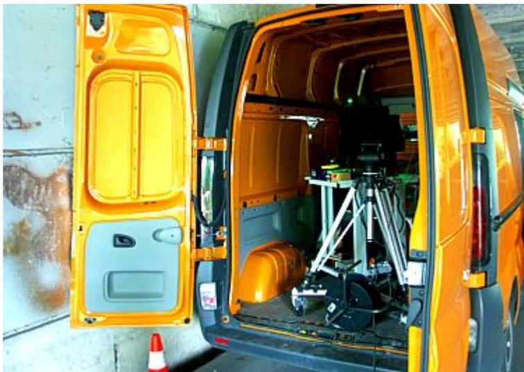
Fig..25 : Dispositif de mesure adapté aux ouvrages d'arts
