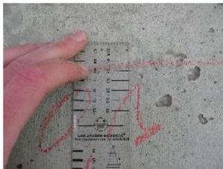
Fig. 1 : Mesure de l'ouverture d'une fissure à l'aide d'un régllet (source LRS)
