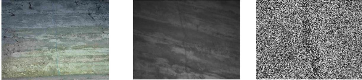
Fig. 43: Détection de fissure par phase en continu. A gauche et au centre, la zone fissurée. A droite, la fissure détectée par une mesure de phase en continue.
