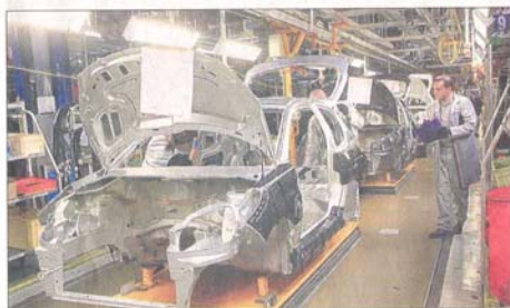
Le soudage laser des caisses économise de la matière, donc permet de gagner du poids sur le véhicule terminé. Archives Thierry Gachon
